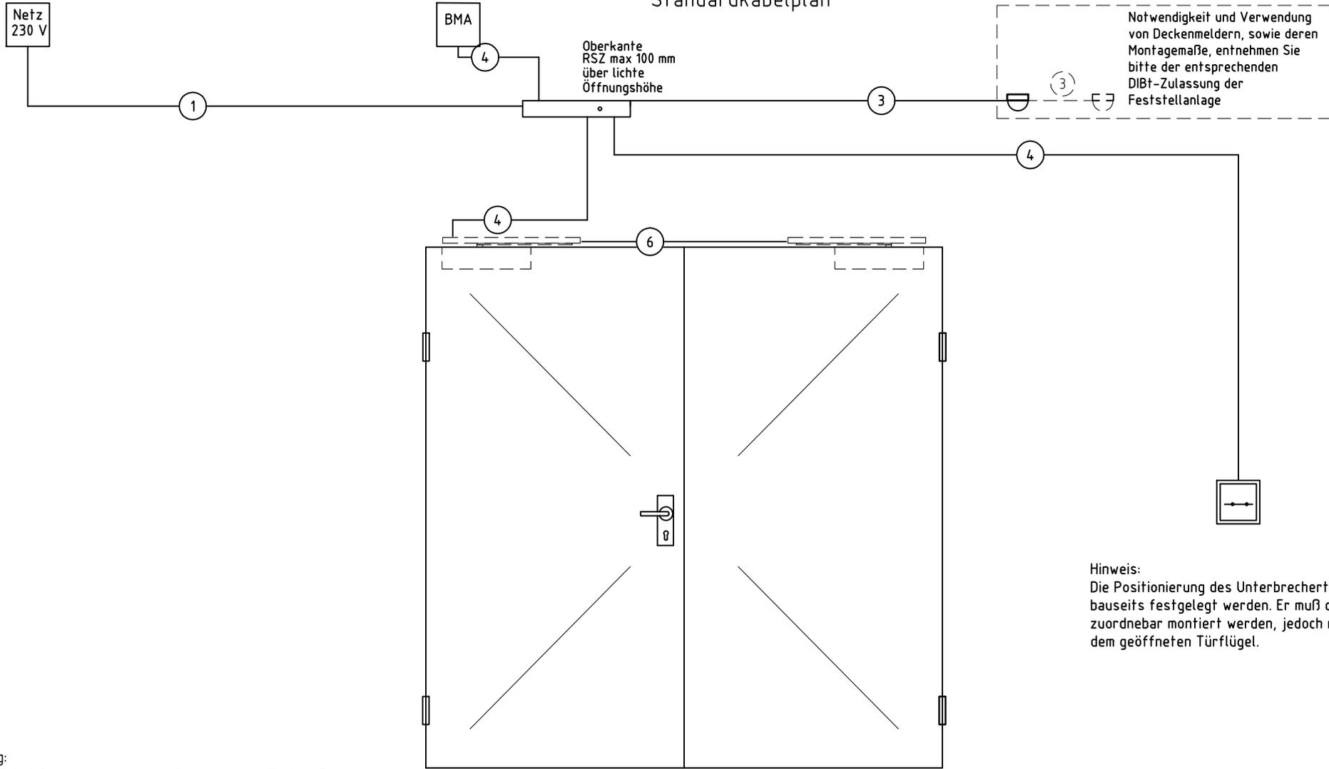
Notwendigkeit und Verwendung von Deckenmeldern, sowie deren Montagemaße, entnehmen Sie bitte der entsprechenden DIBt-Zulassung der Feststellanlage
