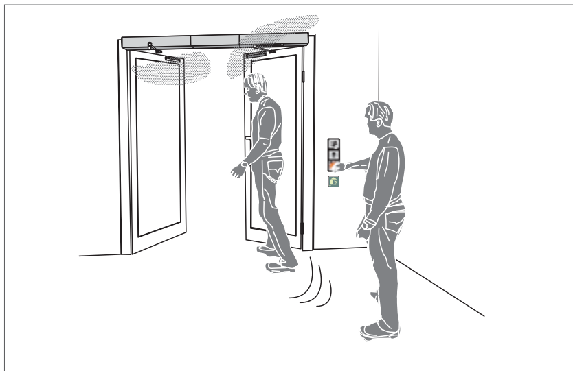
Fig. 06-2 · RWA-Anlage. Darstellung Fluchtsituation
